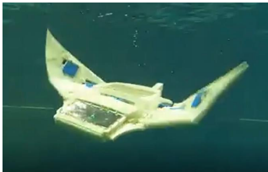
エイを模倣した水中ロボットです。水中を自由に泳ぎます。(AIT-MR-W1、愛知工業大学 Team White a)
